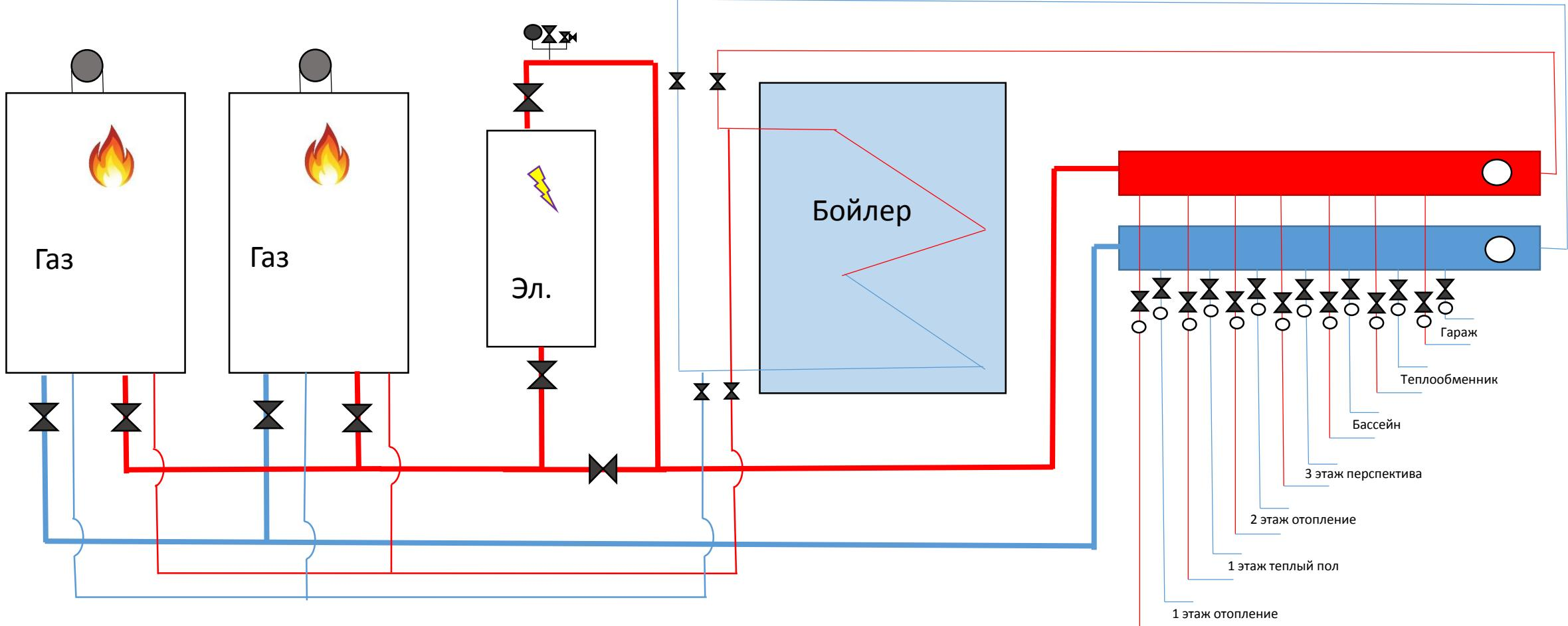
Котельная с автоматическим включением электрического котла
